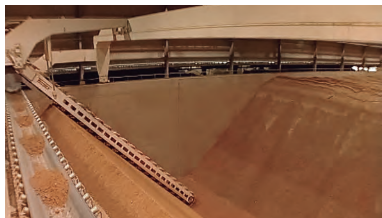
Dragas puente para almacenes en foso y método de llenado Windrow. / Экскаваторы многоковшовые мостовые для запасников ямного типа.
